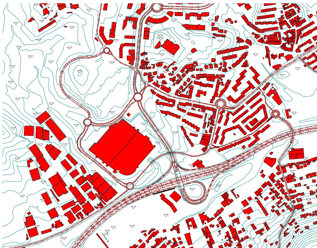
Figura 8 – dados de base do modelo acústico – exemplo para a zona da Figura 7, com curvas de nível, pontos cotados, edificado e implantação das vias de tráfego
